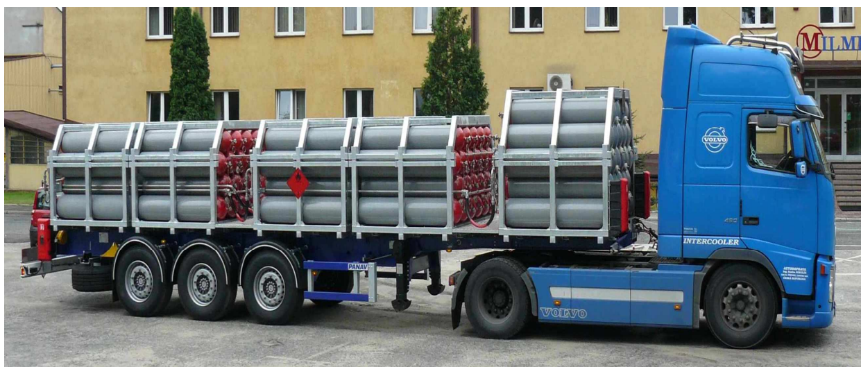
Obr.: Trajler – vodní objem zásobníků 16.872 litrů
